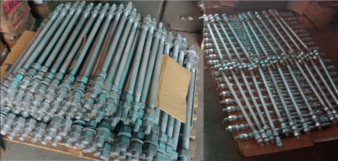
FABRICACIÓN DE PERNOS DE ANCLAJE PARA LA PROYECTO MARCOBRE A TRAVEZ DE HV CONTRATISTAS
